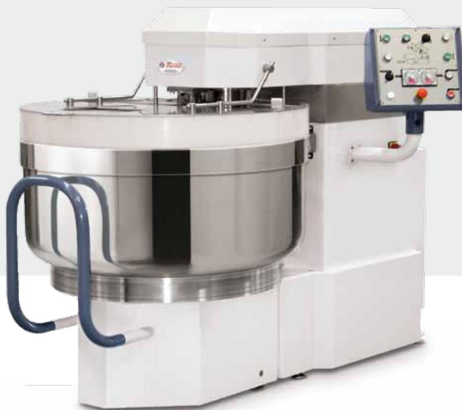
L'impastatrice a spirale automatica con vasca estraibile è una macchina con sollevamento e aggancio automatico. Il sistema di trasmissione del moto alla vasca elimina rumori e manutenzione. La doppia velocità di lavoro della spirale consente l'ottenimento di impasti omogenei e raffinati. La struttura della macchina è in acciaio verniciato di grosso spessore.
