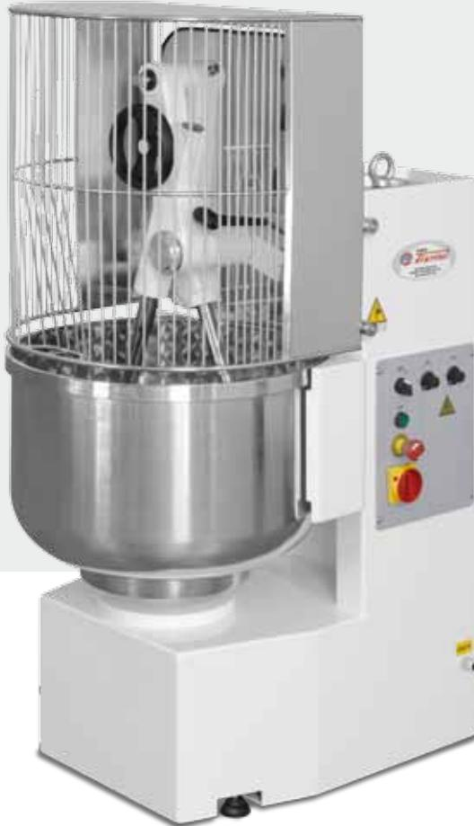
Le impastatrici a braccia tuffanti sono particolarmente indicate in panifici, grissinifici e pasticcerie ed industrie dolciarie. Il particolare sistema a braccia tuffanti ossigena l'impasto non riscaldandolo minimamente, pur avendo una forte velocità di lavoro. La vasca è in acciaio inox. Gli alberi in movimento sono montati su cuscinetti a sfere e gli ingranaggi lavorano in bagno d'olio evitando così una continua lubrificazione.
