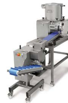
LA MINERVA C/E MBF ΓΡΑΜΜΗ ΠΑΡΑΓΩΓΗΣ ΚΕΦΤΕΔΩΝ ΠΑΡΑΓΩΓΗ 4.000 ΤΜΧ / ΩΡΑ
